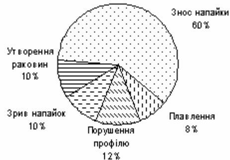
Рис. 3. Причини бракування контактів
