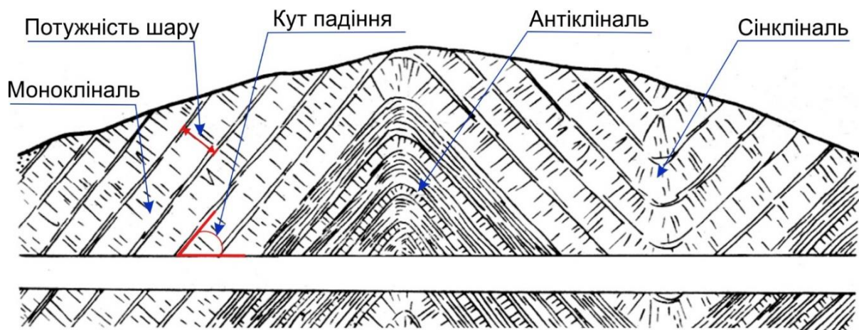
Рис. 2.15. Пересічення тунелем нерозривної дислокації (складки)
