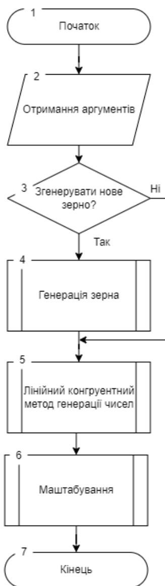
Рисунок 3.2 – Узагальнена блок схема роботи функції генерації псевдовипадкової числової послідовності
