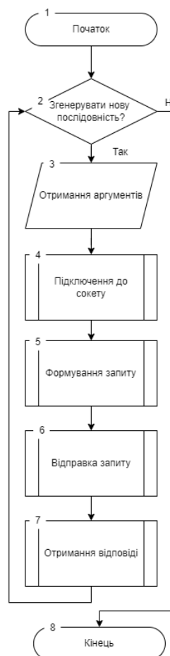
Рисунок 3.5 – Узагальнена блок схема роботи функції комунікації
