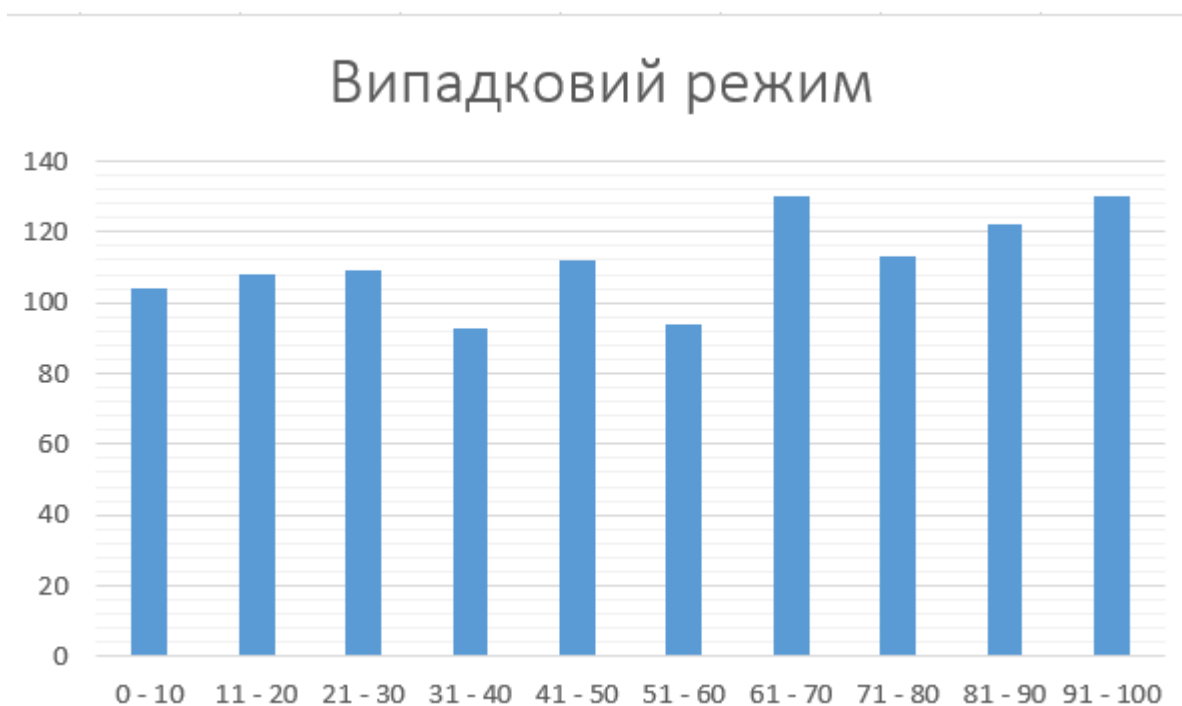
Рисунок 4.2 – Результат розподілу генерації 1000 випадкових чисел
