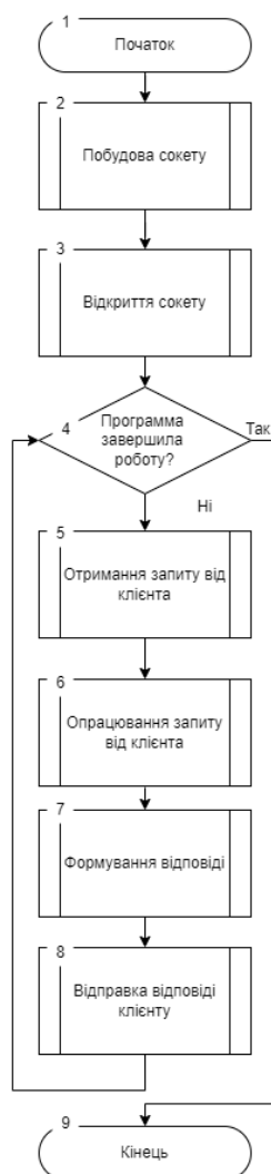
Рисунок 3.4 – Узагальнена блок схема роботи серверної частини
