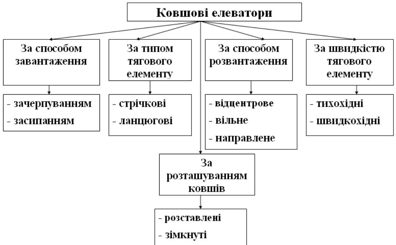
Рис. 1.5. Схема класифікації ковшових елеваторів
