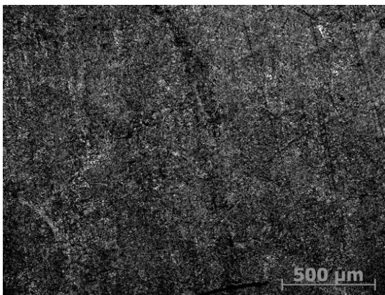
Рисунок 6.48 – Мікроструктура дослідної сталі №К650 К1 після нагріву до температури 1650 °C та подальшого охолодження зі швидкістю \sim 10^4 °C/c
