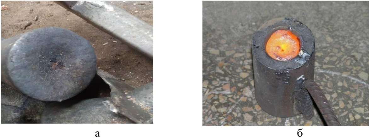
Рисунок 2.2 – Розливання сталі з плавильного модуля (а), графітовий тигель для розливки дослідної сталі (б)
