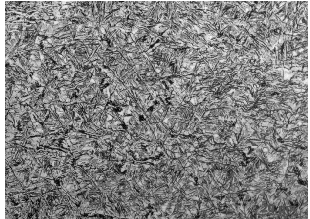
Рисунок 6.39 – Мікроструктура дослідної сталі № K550 (K2) після нагріву до температури 1550 °С та подальшого охолодження зі швидкістю 10 4 °С/с
