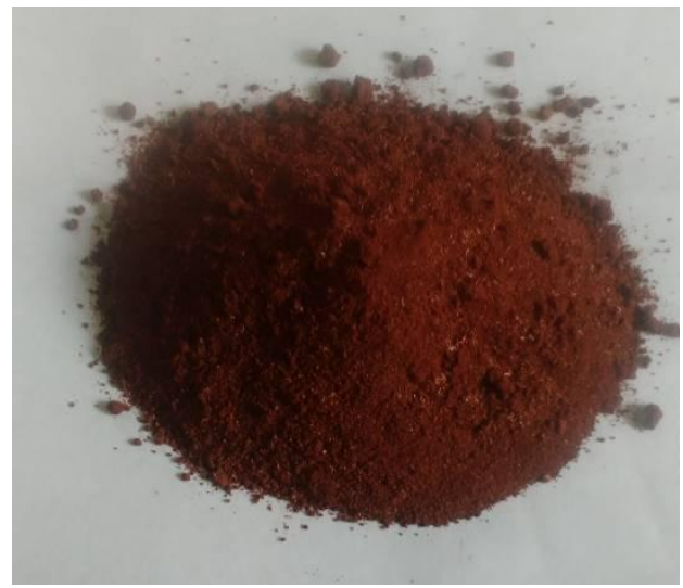
Рисунок 2.4 – Коагулятор шлаку для індукційної печі (а); екзотермічна суміш для обігріву прибутків і виливків (б)
