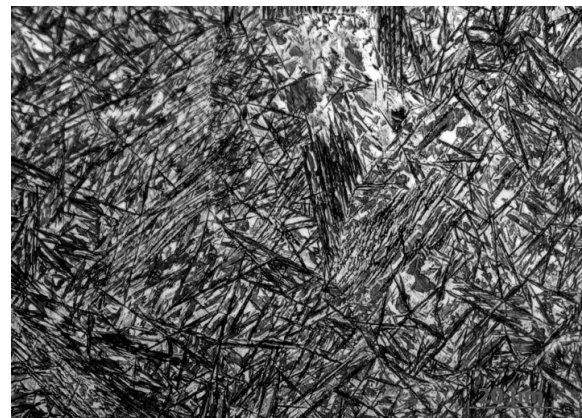
Рис. 6.41. Мікроструктура дослідної сталі № K550 (K2) після нагріву до температури 1650 °С та подальшого охолодження зі швидкістю 10^3 °С/с
