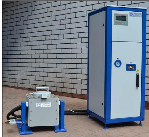
Рисунок 2.1 – Експериментальний комплекс, що включає в себе індукційну плавильну піч ІТПЕ-0,01 і генератор ВТГ-20-22
