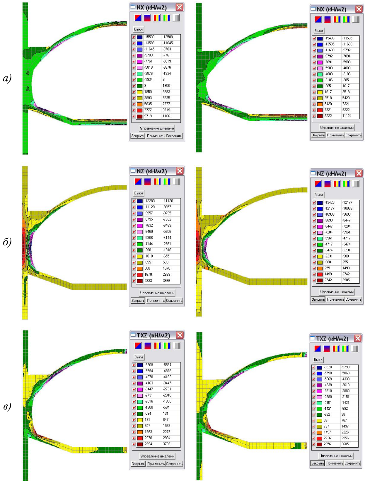
Рис. 23. Ізополя та ізолінії напружень в фрагменті моделі від власної ваги та рухомого навантаження НК-80: а) нормальних по осі X; б) нормальних по осі Z; в) дотичних в площині XZ
