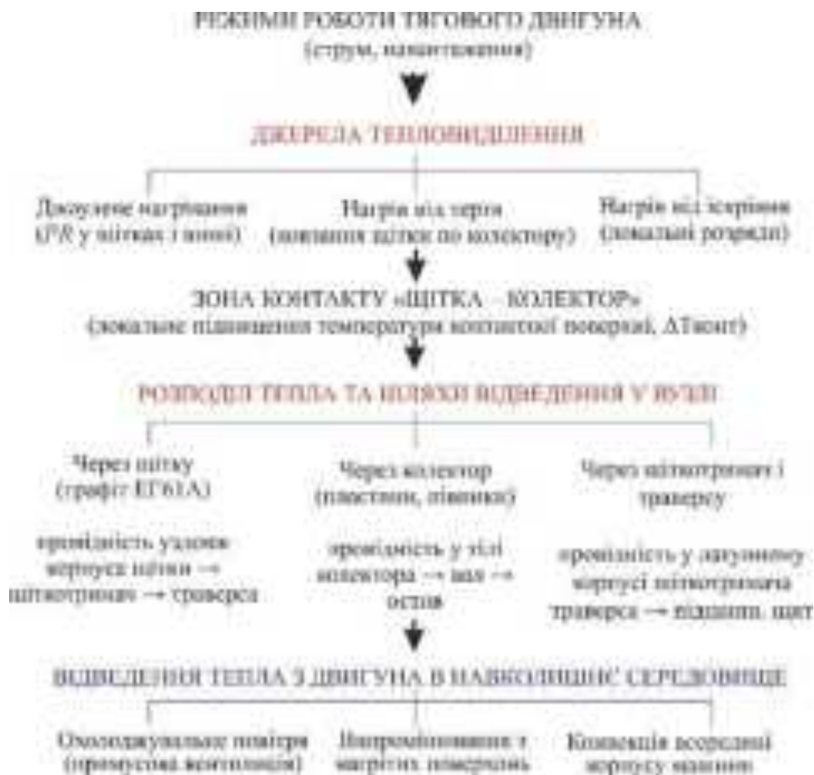
Рисунок 2.14 – Енергетична схема тепловиділення та теплопередачі в щітково-колекторному вузлі
