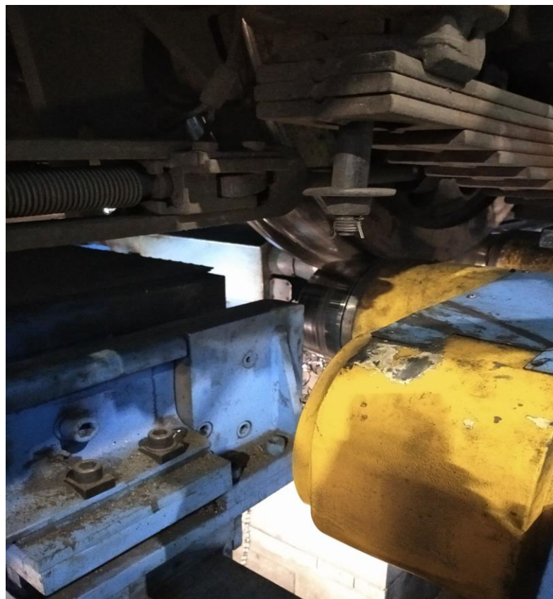
Рисунок 34 – Обточування бандажа колісної пари без викочування
