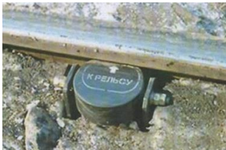
Рисунок 23 – Ідентифікація і підрахунок кількості колісних пар проїждяючого поїзда з допомогою індуктивного датчика.
