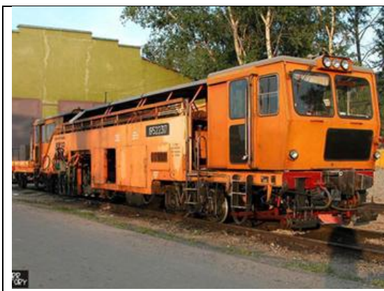
Рисунок 3.5 – Виправочно-підбивочно-рихтувальна машина ВПР - 02 М
