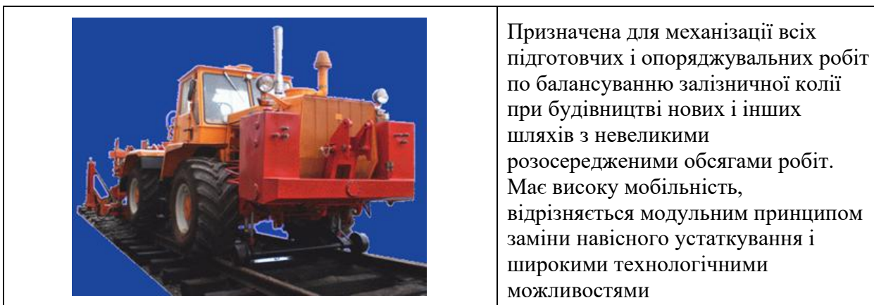
Рисунок 3.3 – Універсальна колійна машина УПМ-1
