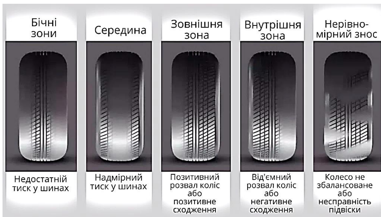
Рисунок 1.3 – Види передчасного зносу протектора шин транспортних засобів.
