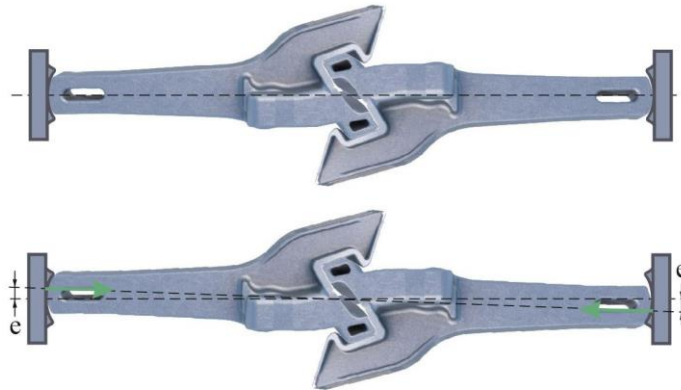
Рис. 2. Передача автосцепками продольного усилия в соединении двух вагонов с эксцентриситетом
