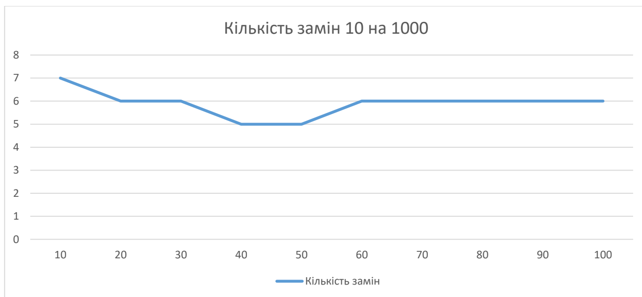
Рисунок 4.11 — Кількість замін на 1000 елементів при коефіцієнті 10
