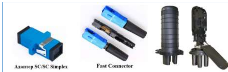
Рисунок 26 – Адаптер, з'єднувач, зварна муфта (оптоволоконно)
