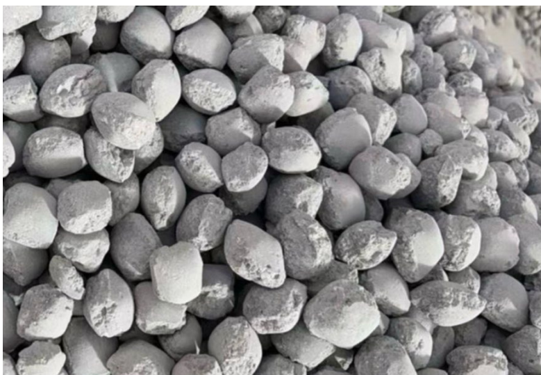
Рисунок 3 - Магнезіальні брикети з високим вмістом кальцію марки RM85C
