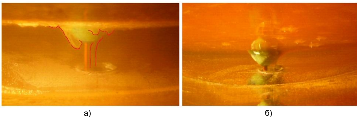
Рисунок 8. Кінограма процесу вторинного відсікання шлаку на моделі конвертера; де а) момент подачі стопору типу «дротик» - вихор навколо головки стопору (червоний контур), б) кінець виливу металу – вихор навколо головки відсутній.
