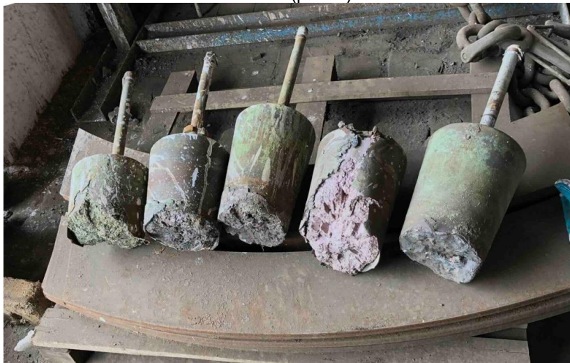
Рис. 3. Основні механізми зносу продувних пробок
