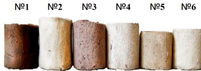
Рисунок 5. Зовнішній вигляд зразків пластичних матеріалів що досліджувались; де зразки №1, №3 – імпортного виробництва («еталонні»); №2, №4-№6 – розроблені склади – аналоги.
