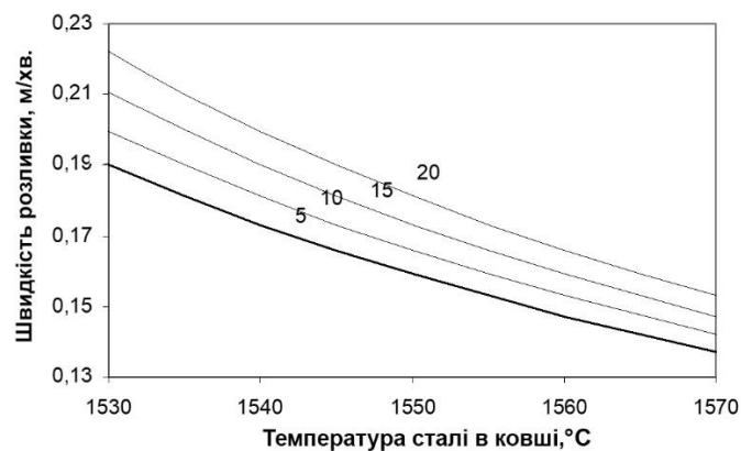
Рисунок 8 – Розрахункова швидкість розливу тіла злитка сталі 70Г (цифри на кривих – час витримки ковша перед розливом у хвиликах)
