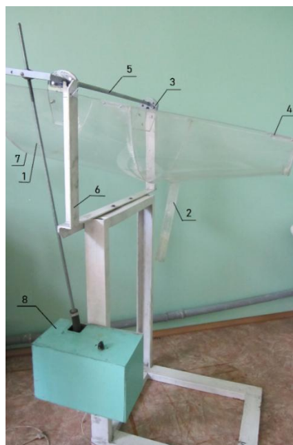
Рисунок 2. Загальний вигляд установки фізичної моделі конвертера в масштабі 1:6; де: 1 – корпус моделі із прозорого оргскла; 2 – лійка (сталевипускний канал); 3 – опорні цапфи; 4 – перекладки жорсткості; 5 – опорна вісь; 6 – вертикальні опори; 7 – днище; 8 – електромеханічний привід нахилу моделі конвертера.
