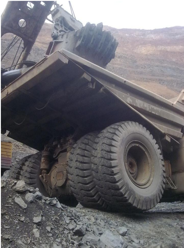
Рис. 1.3. Звисання ведучого колеса кар'єрного самоскида
