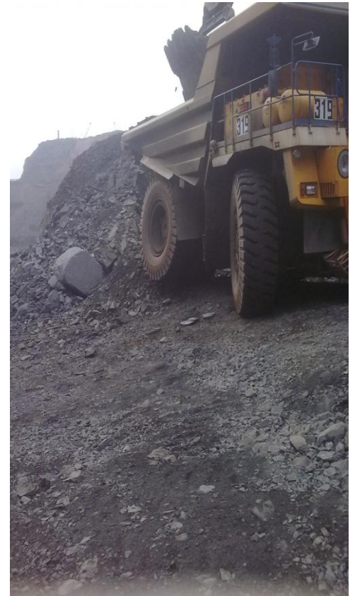
Рис. 1.4. Нерівна поверхня та обмеженість робочого простору обумовлюють сповзання машини
