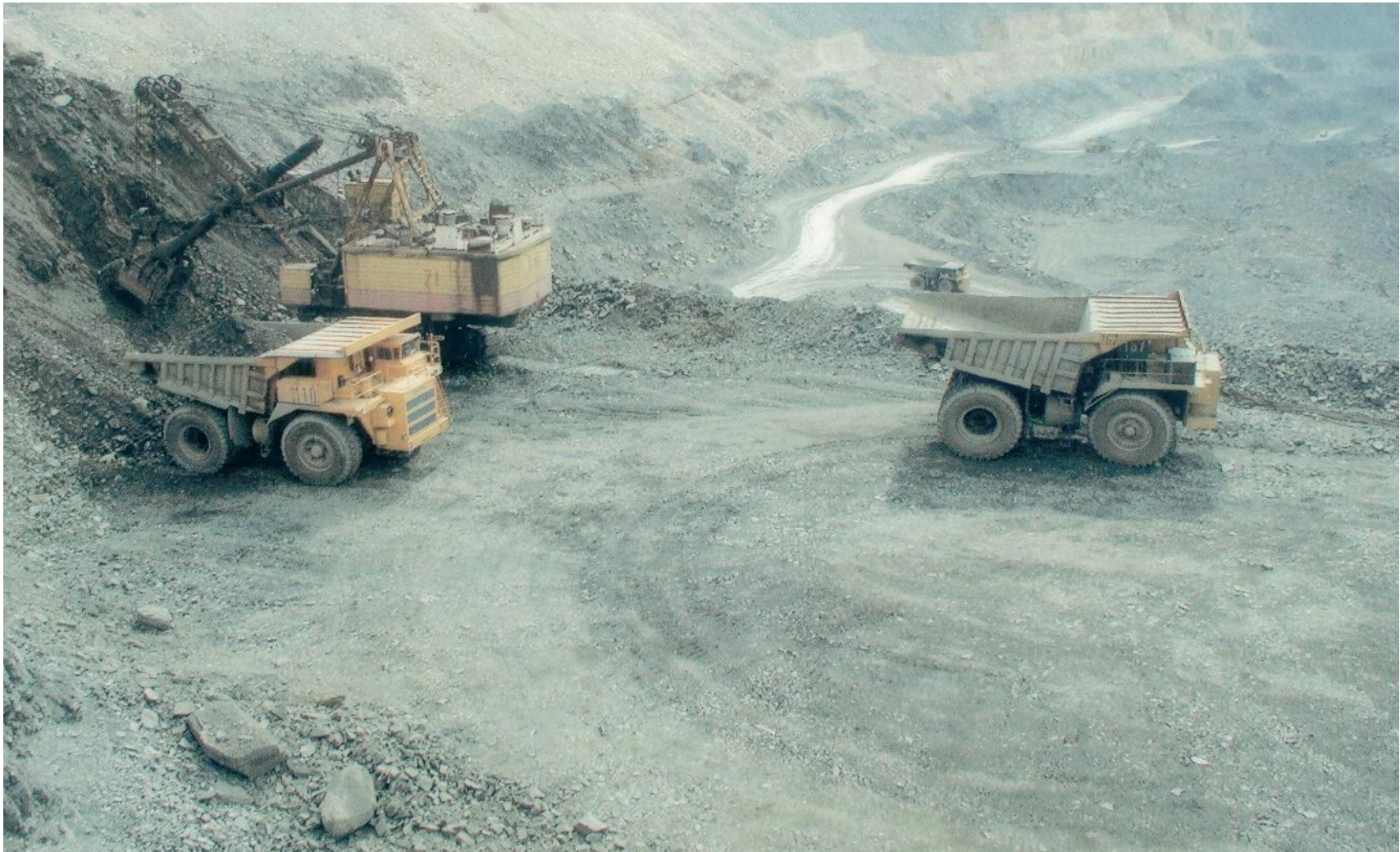
Рис. 4.4. Маневрування кар'єрного самоскида у вибої при застосуванні системи примусового управління
