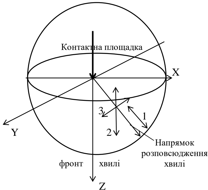
Рисунок 2.16 – Схема фронту розповсюдження хвилі та напрямків коливання часток відносно напрямку розповсюдження хвилі
