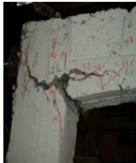
Рис. 1.1 Неструктурні (а) і структурні (б) тріщини у будівельних конструкціях
