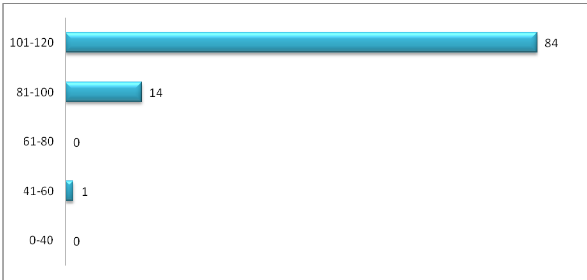
Рисунок 3.2 – Гістограма використання швидкостей на ділянці Сарни - Ковель, при максимальній швидкості пасажирських поїздів по станціям – 100 км/год, по перегонам – 120 км/год.
