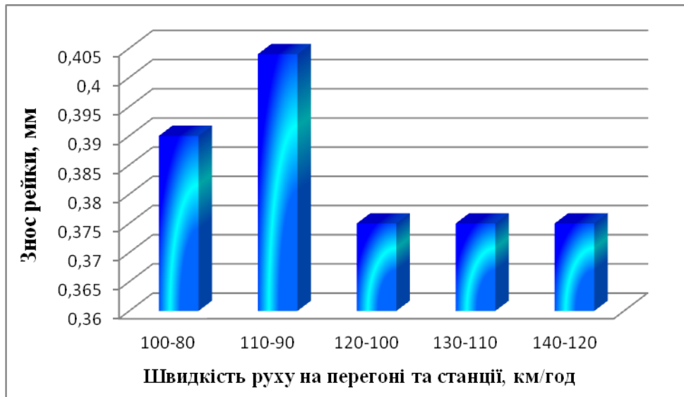
Рисунок 3.30 – Знос рейки на першій точці
