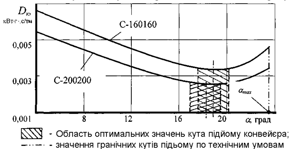
Рисунок 2.2.17 - Залежність питомої дії ( D_K ) стрічкових конвеєрів при русі на підйом від кута нахилу ( \alpha )
