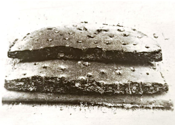
Рис. 14. Зовнішній вигляд та злам диску зі сріблястого графіту і тирси (1:1,5) [10]
