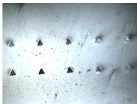
Рисунок 2.2. Вигляд відбитків індентора Берковича при наноіндентуванні (Nanoindenter G200)
