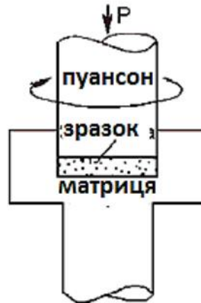
Рисунок 2.1. Принципова схема обробки сталей ІПД методом КГТ [5]
