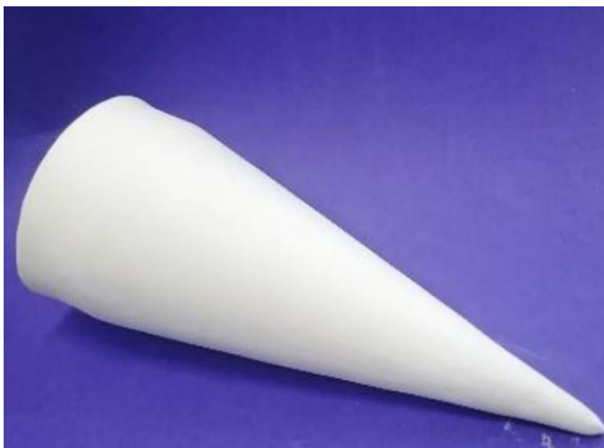
Рисунок 7.4 – Експериментальний зразок надвисокочастотної радіопрозорії кераміки кордієритового складу для носових антенних обтічників
