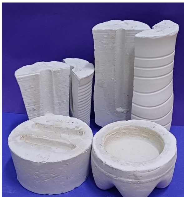
Рисунок 2.1 – Гіпсові форми для лиття зразків дослідної кераміки
