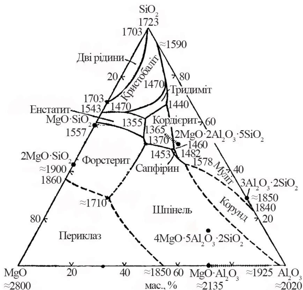
Рисунок 1.3 – Діаграма стану системи MgO - Al_2O_3 - SiO_2 [114]
