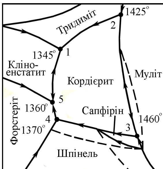
Рисунок 3.4 – Частина системи \text{MgO} - \text{Al}_2\text{O}_3 - \text{SiO}_2 з інваріантними точками 1–5, в яких однією з кристалічних фаз є кордієрит
