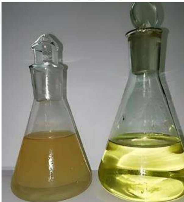
Рисунок 3.8 – Зразок МЕЖК після тривалого зберігання: без додавання КЗРБС (ліворуч) та з його додаванням (праворуч).
