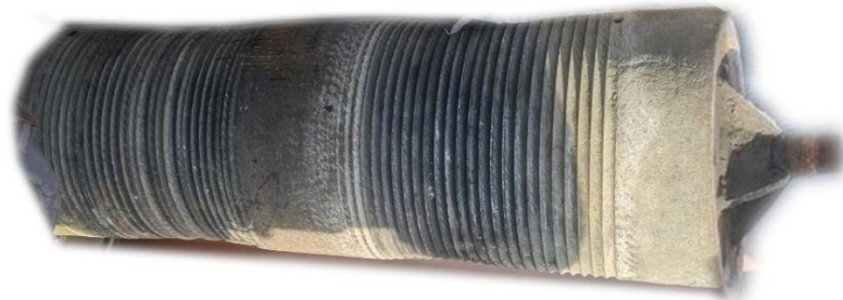
Рисунок 1 – Барабан лебідки ВПМ після тривалого терміну експлуатації
