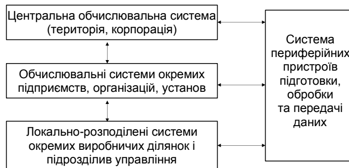
Рис. 1. Принципова схема багаторівневої організації програмно-технічних засобів локальної обчислювальної мережі
