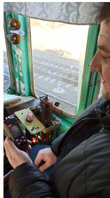
Рис. 4.1. Вимірювання рівня шуму у кабіні локомотива
