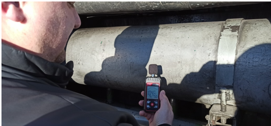
Рис. 4.5. Результати вимірювання шумового навантаження ззовні локомотива (продовження).
