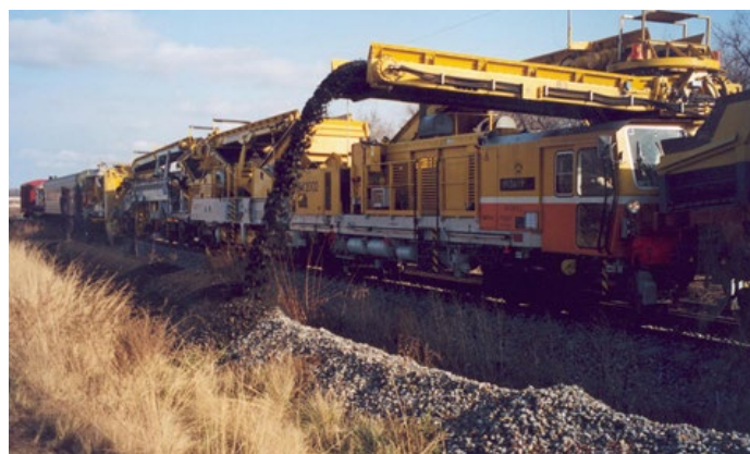
Рис. 3.7 Колійна машина на очищення баласту RM-80
