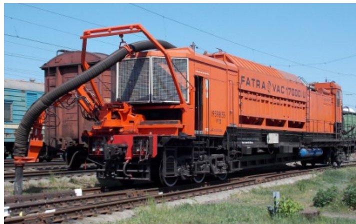
Рис. 3.6 Вакуумний навантажувач баласту
