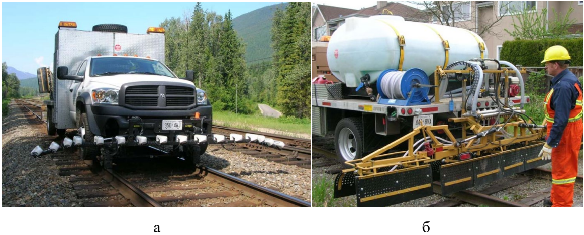
Рисунок 3.1 Спеціальна техніка для розпилення гербіцидів на канадській залізниці [фото Canadian Pacific Railway]
