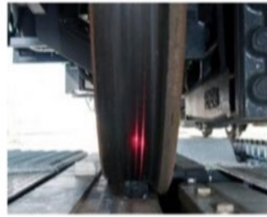
Рисунок 4.3 – Робота лазерних датчиків контролю системи “ARGUS”
