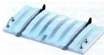
Рисунок 21 – Дах люка вагона-хопера
