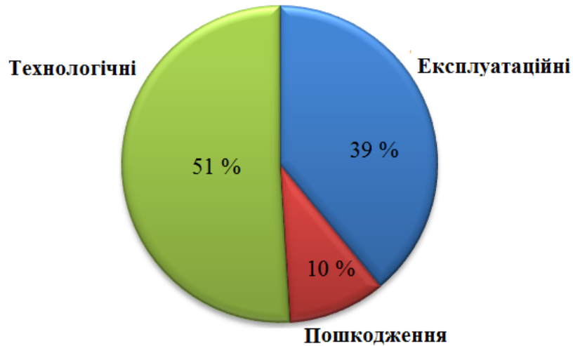
Рисунок 5 – Розподіл несправностей вантажних вагонів АТ «Укрзалізниця» за 2016-2022 роки в залежності від причин їхнього виникнення [11].
