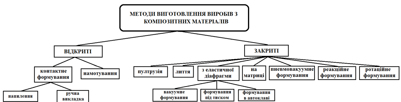
Рисунок 16 – Класифікація методи виготовлення виробів з композитних матеріалів
