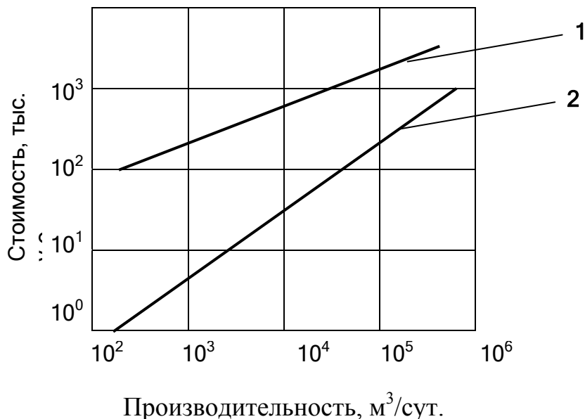
Рис. 34. Стоимость электроимпульсной установки: 1 – стоимость разработки; 2 – себестоимость при серийном производстве
