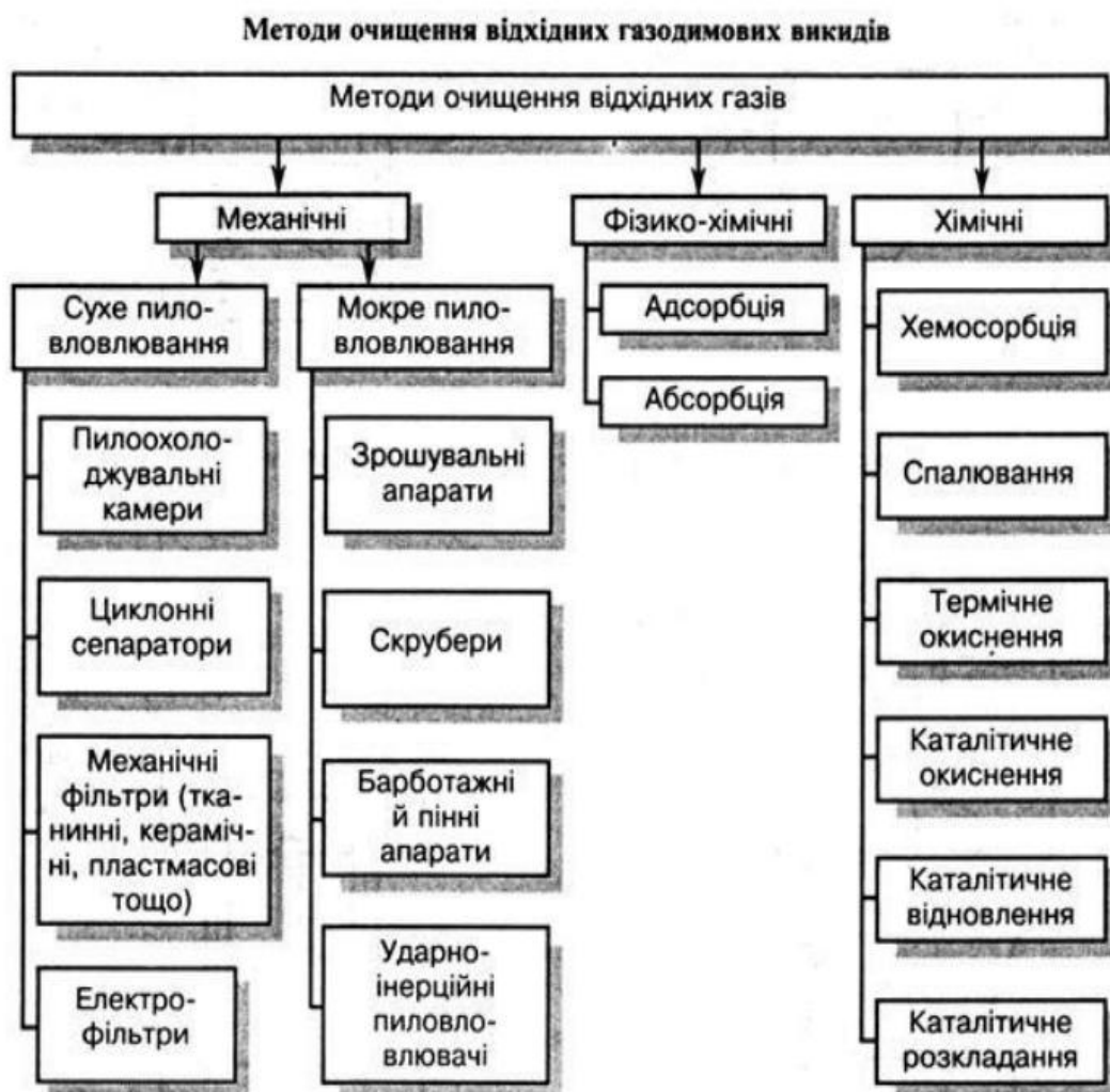
Рисунок 11.3 Методи очищення газодимових викидів [джерело 4 стор.30]
