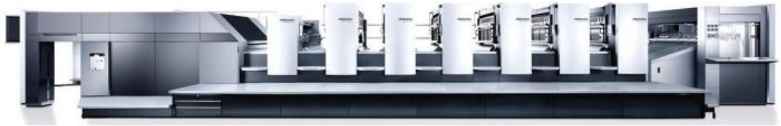
Рисунок 5.1.2 – Листова офсетна машина Heidelberg Speedmaster CD 102
