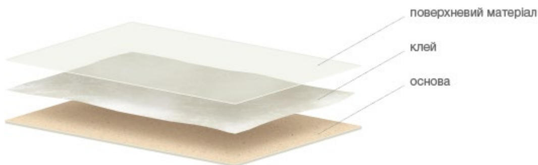
Рис. 1.4.1 Схема складових частин етикеток
