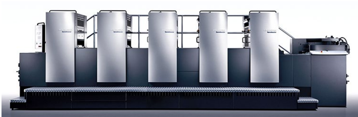
Рис. 2.2.1 Друкарська офсетна листова машина Heidelberg Speedmaster 74-4-P-H
