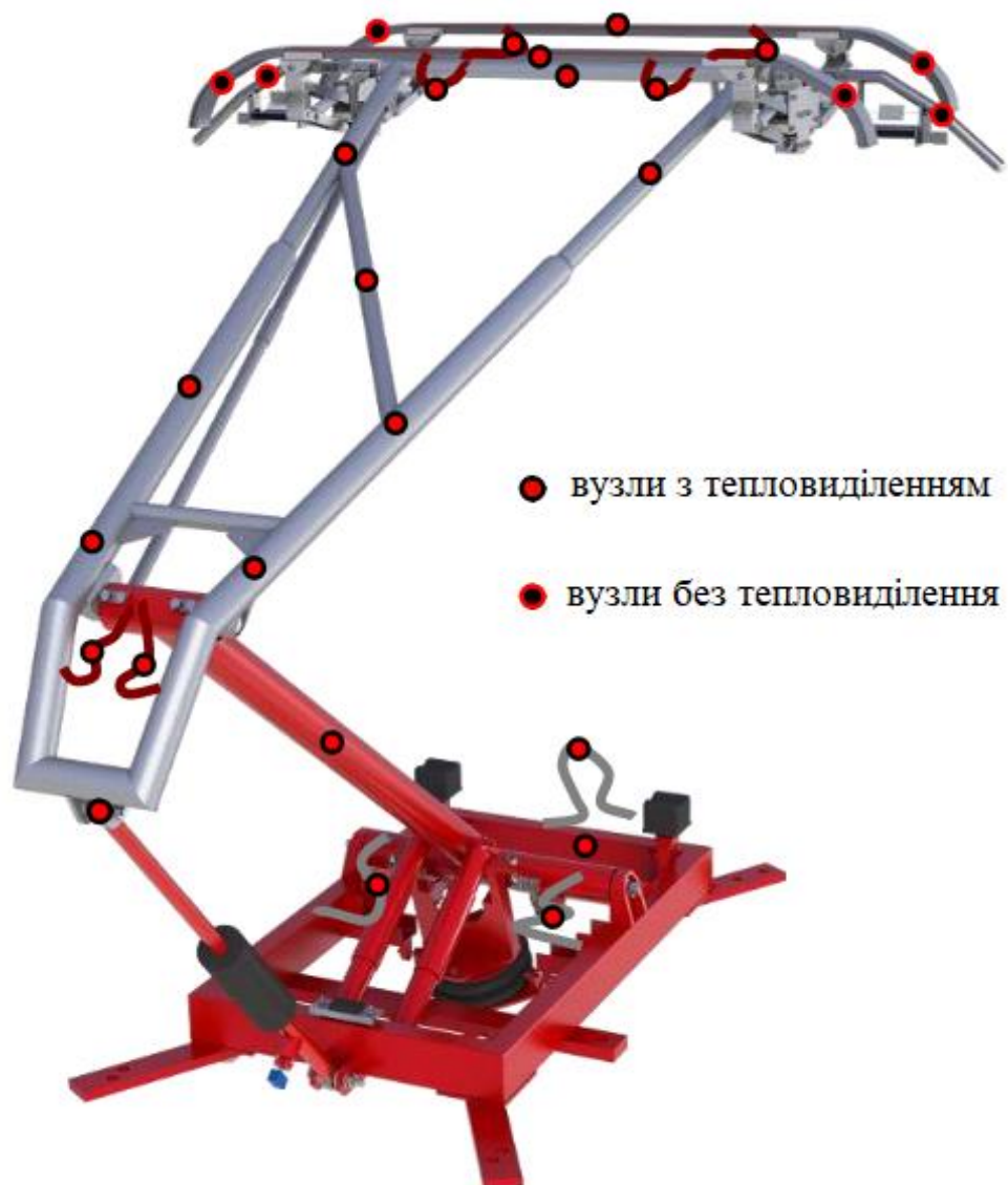
Рисунок 3.1 – Карта температур вузлів струмоприймача
