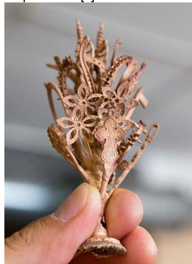
Рисунок 4 – Блок виливків [ https://silver-ua.com/sozdanie-voskovej-yolki/ ]
