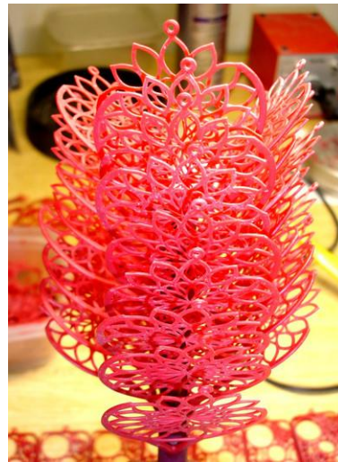
Риснок 2 – Воскова «ялинка», готова для формовки [ https://silver-ua.com/sozdanie-voskovej-yolki/ ]
