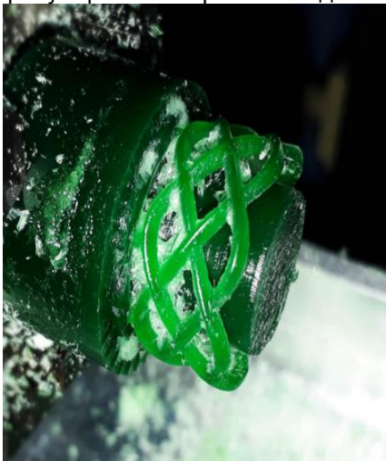
Рисунок 1 – Воскова модель каблучки, фрезерована на верстаті [ http://jewel-wax.com.ua/ ]
