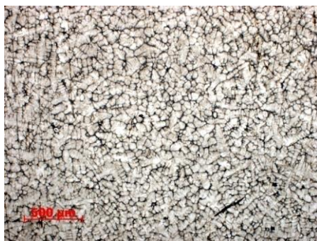
Рис. 3. Мікроструктура зразків: а) БЛЗ сталі №1 в центральній частині; б) при нагріві сталі №2 на 50 °C вище температури ліквідусу та охолодження зі швидкістю 10^3 °C/c; в) при нагріві на 150 °C вище температури ліквідусу та охолодження зі швидкістю 10^3 °C/c, \times 100
