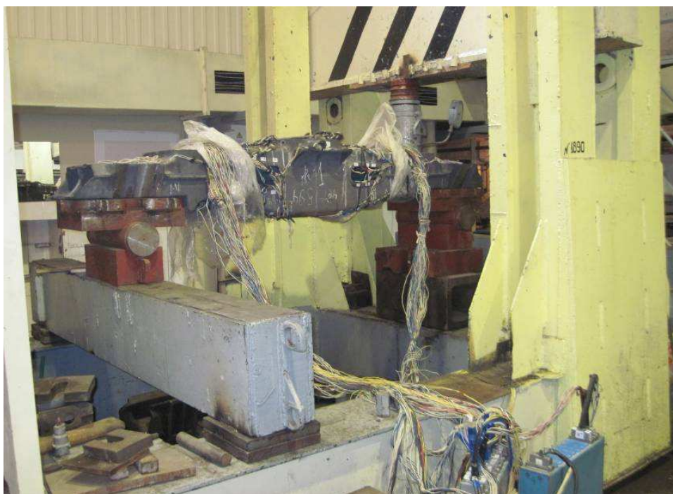
Рис. 3.3 – Приложение вертикальных нагрузок на пятник (а) и на скользян (б) надрессорной балки
