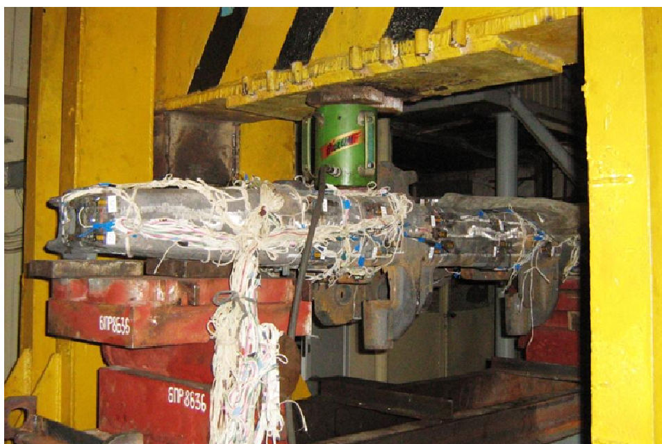
Рис. 3.5 – Приложение вертикальных (а) и поперечных (б) нагрузок к боковой раме
