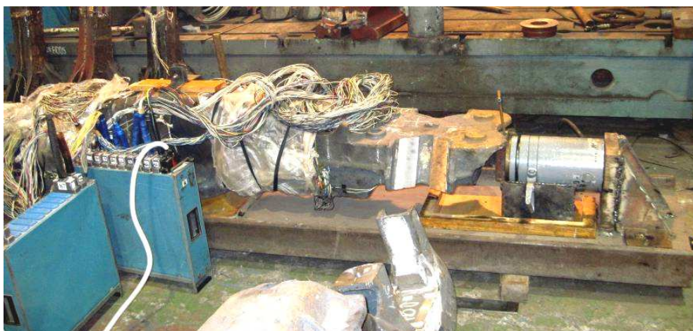
Рис. 3.4 – Приложение горизонтальных нагрузок к надрессорной балке в продольном (а) и поперечном (б) направлениях
