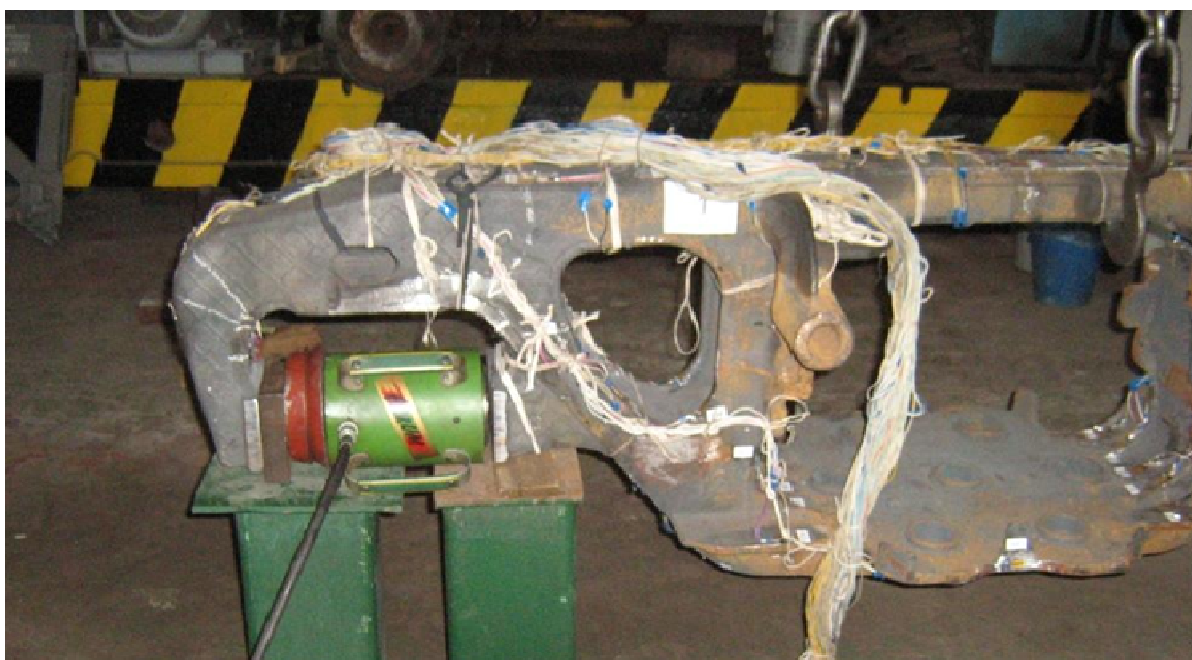
Рис. 3.6 – Приложение горизонтальных нагрузок к боковой раме в рессорном (а) и буксовом (б) проемах
