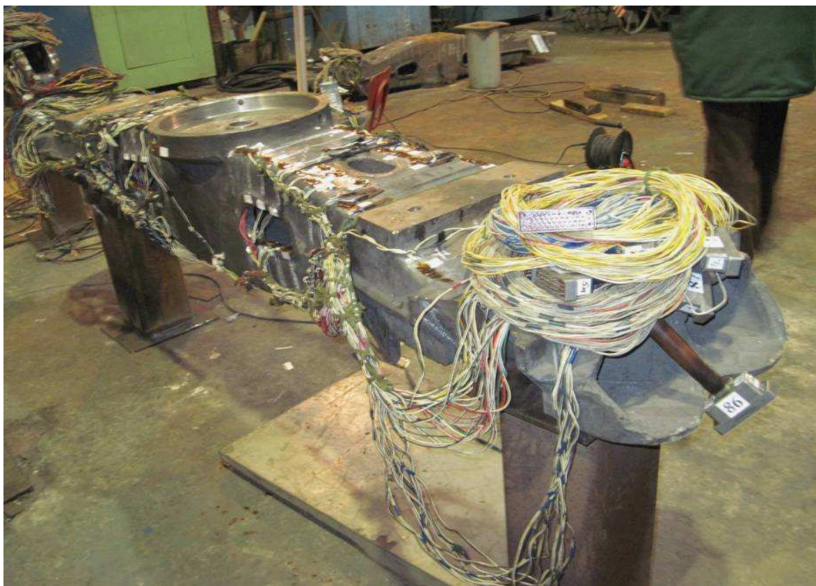
Рис. 3.1 – Установка тензорезисторов (а) и монтаж измерительных схем (б) на надressорной балке
