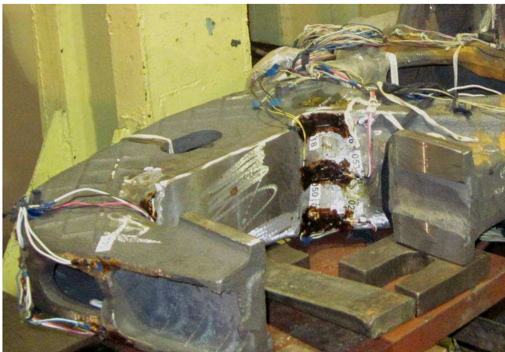
Рис. 3.2 – Установка тензорезисторов и монтаж измерительных схем на боковой раме
