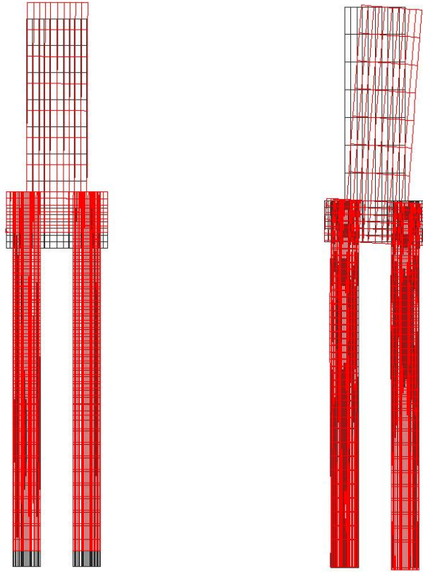
1 форма, частота 4,2 Гц 2 форма, частота 10,7 Гц
