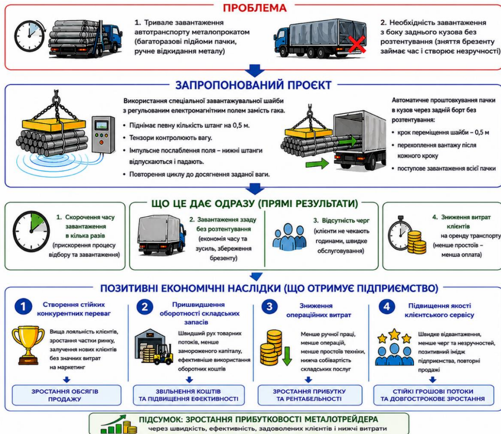
Рис. 2.1 – Пропозиції з автоматизації процесу завантаження металопрокату на вантажівки та їхні економічні наслідки
