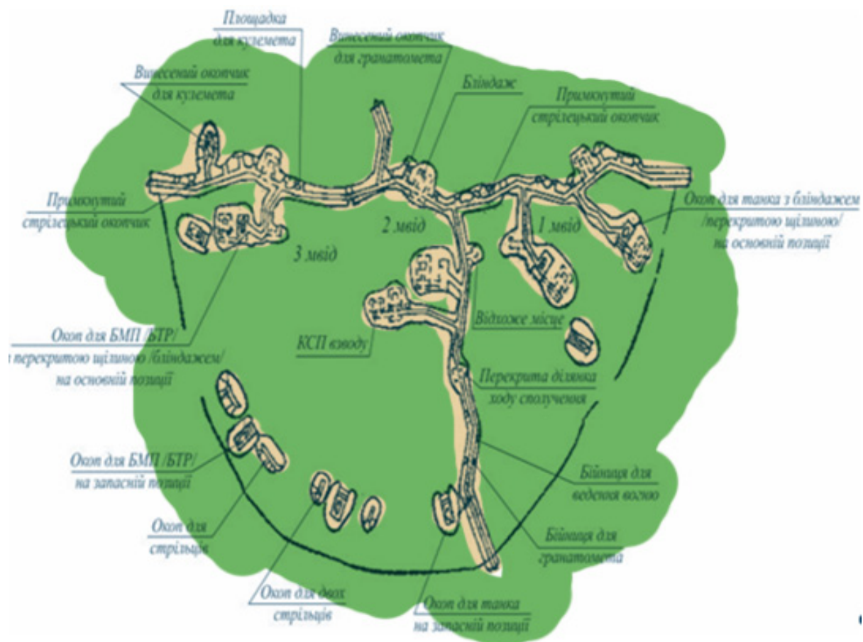
Рис. 3.45. Фортифікаційне обладнання опорного пункту механізованого взводу другого ешелону роти (варіант)
