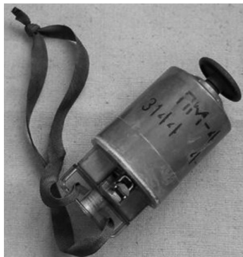
Рис. 5.35. Підризна машинка ПМ-4
