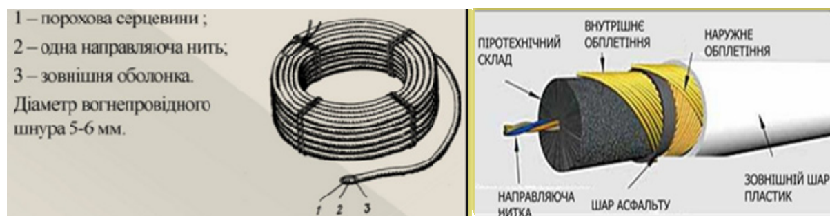
Рис. 5.14. Загальна будова вогнепровідного шнура
