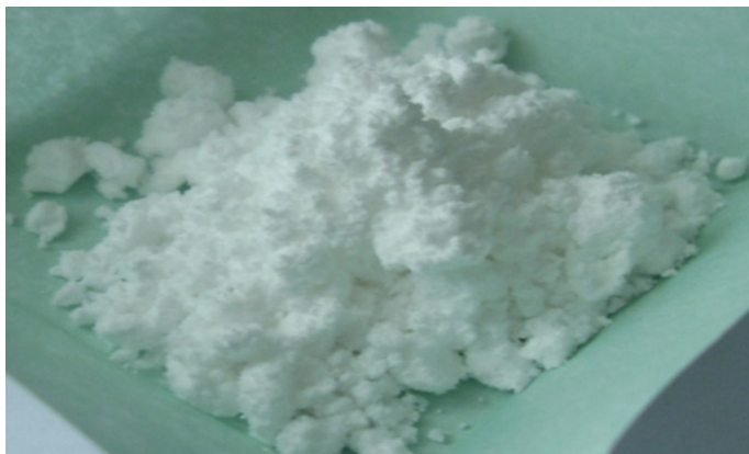
Рис. 5.4. Тен (тетранітропентаеритрит, пентрит)
