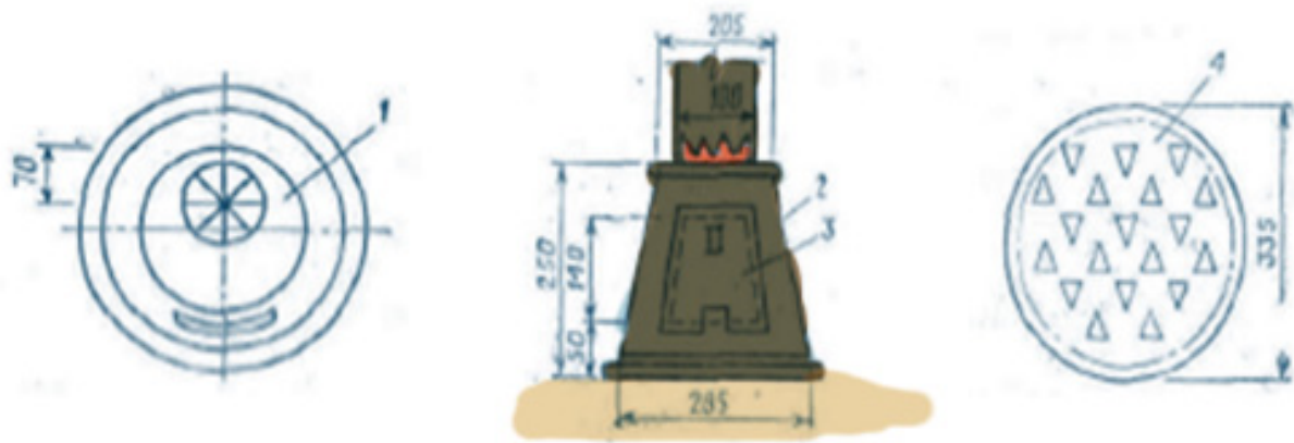
Рис. 3.40. Піч з відра (розміри вказані в міліметрах):
