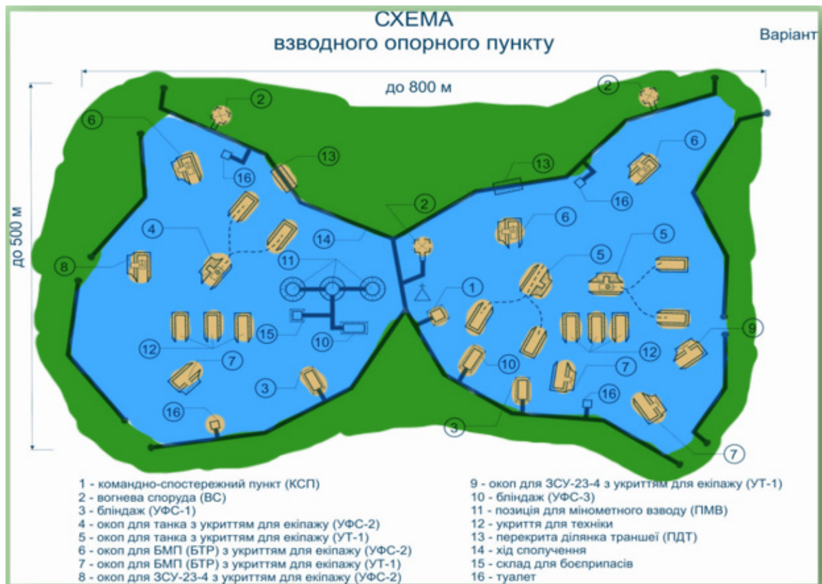
Рис. 3.12. Варіант влаштування окопів взводного опорного пункту шляхом ламаного креслення
