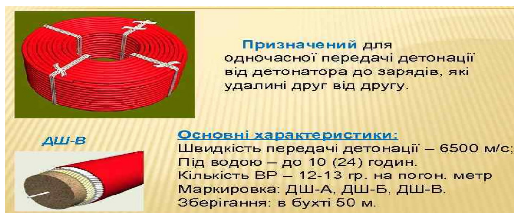
Рис. 5.15. Детонуючий шнур ДШ-В
