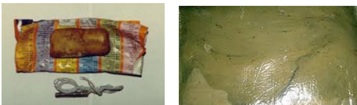
Рис. 5.9. Пластична ВР (пластит, ПВВ-4)
