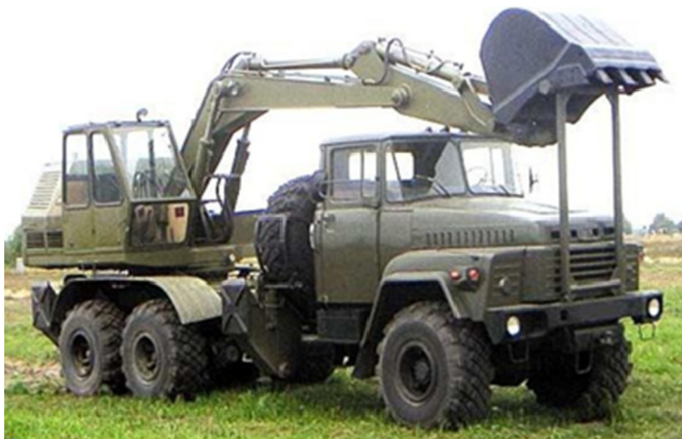
Рис. 3.65. Загальний вигляд військового гідравлічного одноковшового екскаватора ЕОВ-4421
