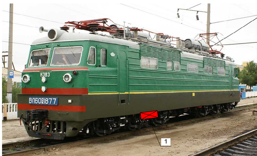
Рис. 5.68. Підривання електровоза: 1 – заряд на моторно-осьових підшипниках
