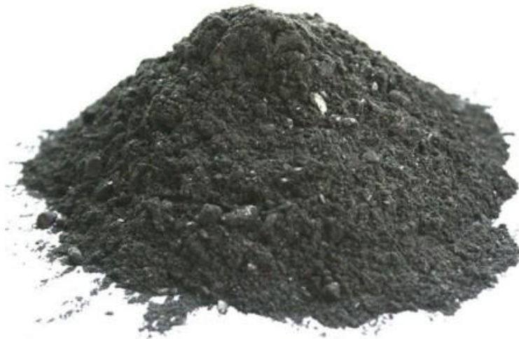
Рисунок 3.2 Органомінеральний сорбент нафтопродуктів ЕКОЛАН[14]
