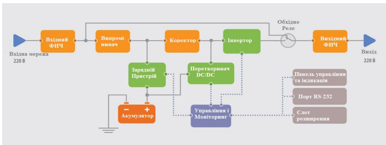
Рисунок – 1.2 Схема онлайн безперебійника з подвійним перетворенням
