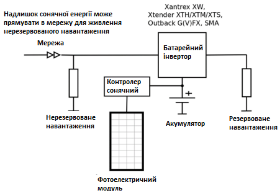
Рисунок 2.3 – Схема мережева фотоелектрична система електропостачання контролером заряду постійного струму
