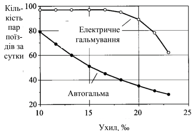
Рисунок 1.19 – Кількість пар поїздів на добу на ділянці зі спуском в залежності від системи гальмування поїзда і ухилу ділянки
