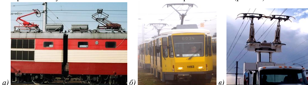
Рис. 1. Використання пантографа: а) – на електровозі; б) – на трамваї; в) – на автомобілі
