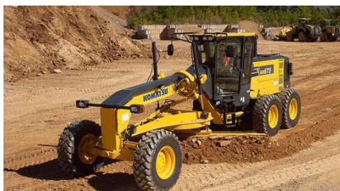
Рис. 1. Грейдер - виймально-транспортна та землерийно-планувальна машина, якою планують і профілюють земляні насипи, переміщують і розрівнюють ґрунт
