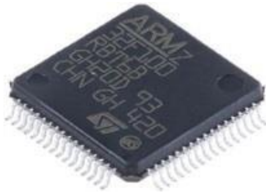
Рисунок 3.5 – Зображення мікроконтролера STM32F100C4T6B
