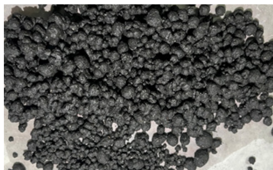
Рис. 3. Фото огрудкованої агломераційної шихти на виході з барабана-змішувача. Вологість — 13,5 %
