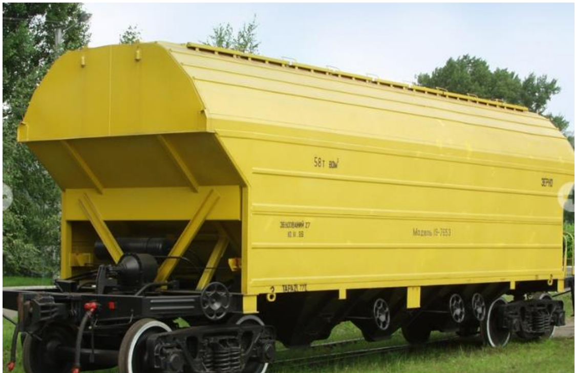
Рис.2.5. Вагон для зерна моделі 19-765
