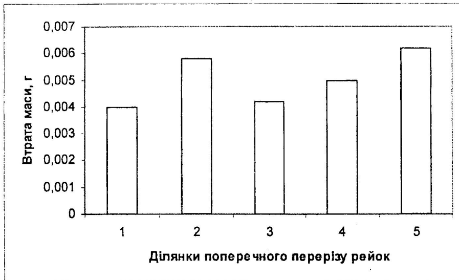
Рис. 18. Результати випробовувань на зношування зразків з механічно обробленою поверхнею: 1 – верх головки рейки; 2 – низ головки рейки; 3 – верх шийки рейки; 4 – низ шийки рейки; 5 – низ підшви рейки
