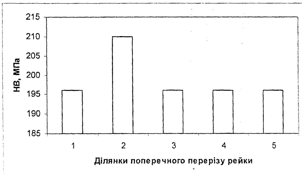
Рис. 16. Твердість зразків, вирізаних з різних частин нероз'ємного з'єднання для випробовування на зношування: 1 – верх головки рейки; 2 – низ головки рейки; 3 – верх шийки рейки; 4 – низ шийки рейки; 5 – низ підшви рейки
