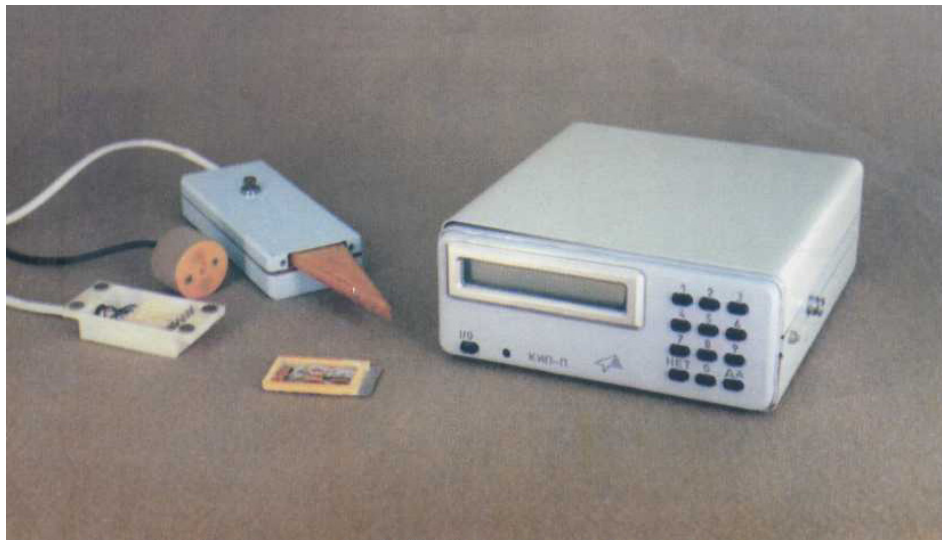
Рис. 29. Тензорезисторний прилад для вимірювання температурних напружень у рейкових плітях безстикової колії
