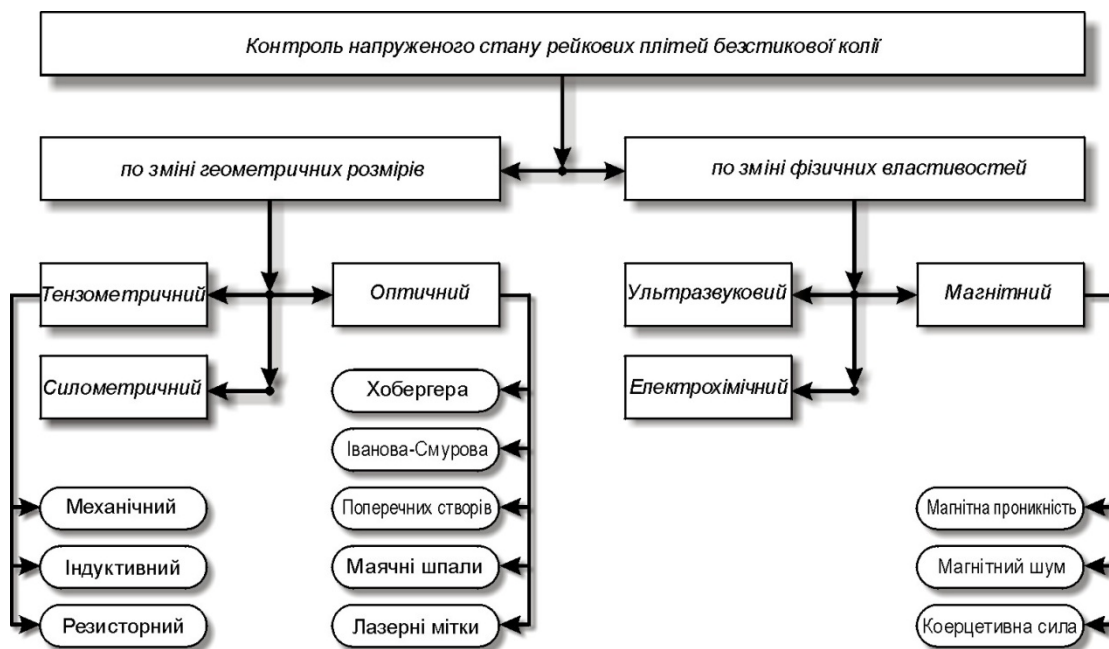
Рис. 26. Класифікація методів контролю напружень у рейкових плітях
