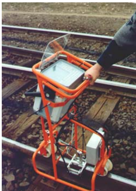
Рис. 31. Прилад для вимірювання напружень методом магнітного шуму
