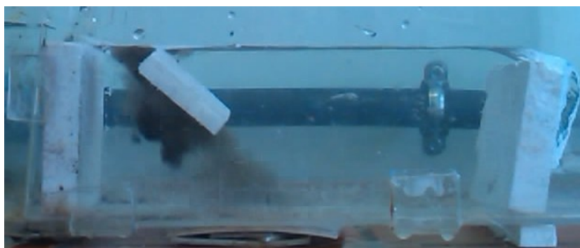
Рисунок 6.1 – Зона забруднення у відстійнику з однією похилою пластиною ( t = 0,3 с)
