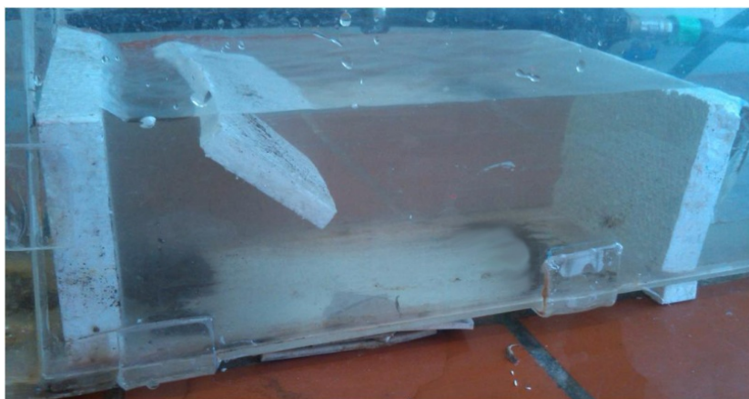
Рисунок 6.3 – Зона забруднення у відстійнику з однією похилою пластиною
