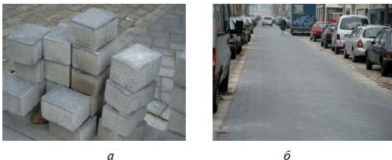
а) – блоки, що містять TiO_2 як додаток; б) – дорога з поглинаючим покриттям
